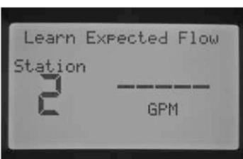
Как только отобразится корректный номер зоны, переместите тумблер в положение Run. Контроллер снова вернется в режим диагностирования потока для конкретной зоны. Контроллер запустит зону, процесс изучения может занять до 1 минуты. Как только контроллер изучил ожидаемый поток, он отключит зону и вернется к отображению текущей даты/времени.
