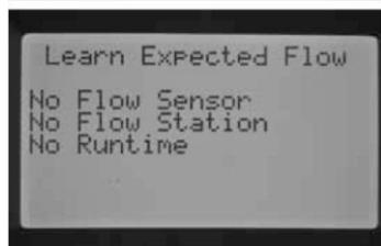
Если Вы хотите изучить ожидаемый поток для всех зон, просто переместите тумблер в положение Run. Контроллер вернется в режим диагностики актуального потока для каждой зоны, которая была предварительно запрограммирована для отслеживания потока.
