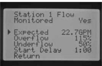
(Продвинутые возможности) и используйте кнопку для выбора управления потоком. Отобразится ожидаемый поток. Ожидаемый поток может быть изменен в ручном режиме в этом диалоговом окне, или Вы можете выполнить повторное считывание данных, как описано выше. Эту процедуру необходимо выполнить, если были установлены дополнительные дождеватели, удалены существующие, или были заменены форсунки.
