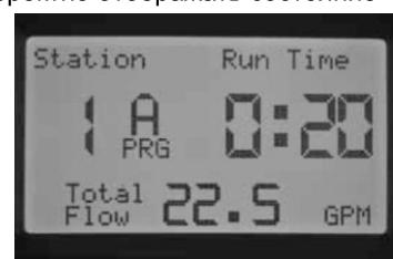
Если I-CORE определяет недостаток или избыток потока по истечению задержки старта, индикатор состояния датчика станет постоянно красным, и контроллер перейдет к выполнению самодиагностики.
