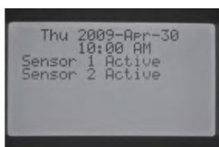
Если зона была запрограммирована на распознавание датчика в положении тумблера SET SENSOR OPERATION, контроллер будет приостанавливать полив этих зон.
