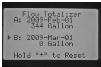
**ПРИМЕЧАНИЕ:** счетчик потока не будет сброшен, если выполняется функция Erase All. Это обеспечивает сохранность данных о потоке после выполнения сброса на контроллере.
