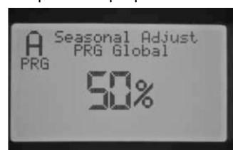
**Сезонное регулирование по месяцу (Monthly Seasonal Adjust)** – Все значения сезонного регулирования на целый год могут быть запрограммированы в контроллер за один раз. Каждый месяц контроллер будет переключаться на новое запрограммированное значение сезонного регулирования.
