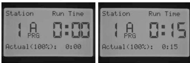
Нажатием кнопки PRG, Вы можете перемещаться между программами, оставаясь в положении на той же зоне. Тем не менее, рекомендуется завершить работу с одной программой перед переходом к следующей.
