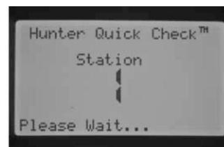
Контроллер начнет поиск всех зон для обнаружения превышения нормы на проводке по клеммам зон. Если обнаружено короткое замыкание на зоне, контроллер отобразит сообщение об ошибке.
