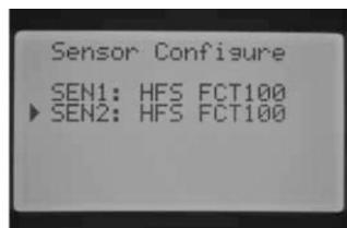
4. Для датчиков потока других производителей могут быть заданы типы датчиков: Custom 1, Custom 2, или Custom 3. Выбрав тип датчика, нажмите кнопку **▶** для программирования значений K-Factor и Offset, которые являются специфическими для каждого конкретного датчика и заданы производителем датчика потока.
