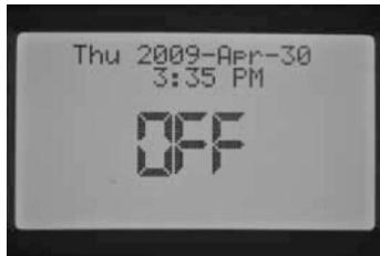
Так же возможно задать программируемый период, на который контроллер будет оставаться выключенным в положении тумблера System Off. Эта функция называется Programmable Rain Off (Программируемое отключение при дожде) и будет рассмотрена в соответствующей главе.
