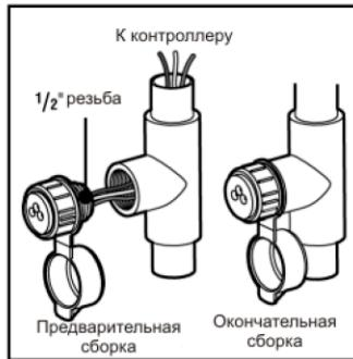
1. Установите во временном кабелепроводе ниже контроллера Pro-C примерно на 30 см тройник с внутренней резьбой в 1/2".
