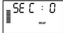
**ПРИМЕЧАНИЕ:** Выключатель главного клапана/насоса будет включен в течение первой минуты любого запрограммированного времени задержки, чтобы надежно дожать закрывающийся вентиль главного клапана и тем самым предотвратить нежелательные сбои в цикле полива. Так как вентиль может закрыться раньше, то в течение оставшейся до конца 1 минуты времени давление в системе будет возрастать. Поэтому рекомендуется установить перепускной клапан давления.
